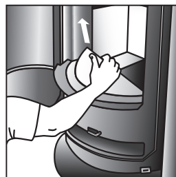
Auswechseln der Feuerraumauskleidung (mit dem vordersten Stein beginnen)
